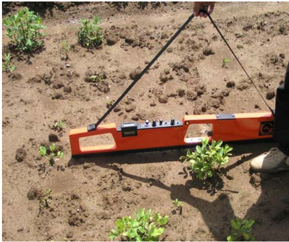
Gambar 2. Pertumbuhan tanaman yang buruk akibat salinitas di Pante Raja, Pidie. Nampak pengukuran salinitas menggunakan alat EM38.
