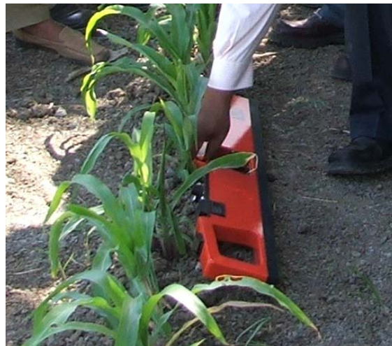
Gambar 5. Pengukuran menggunakan EM38 dengan posisi rebah
