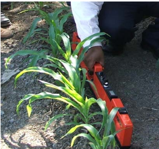
Gambar 4. Pengukuran menggunakan EM38 dengan posisi tegak
