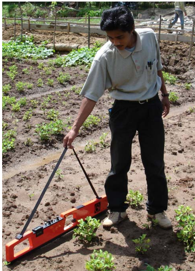
Gambar 1. Alat induksi elektromagnetik (EM38) digunakan untuk mengukur salinitas tanah akibat tsunami di NAD.
